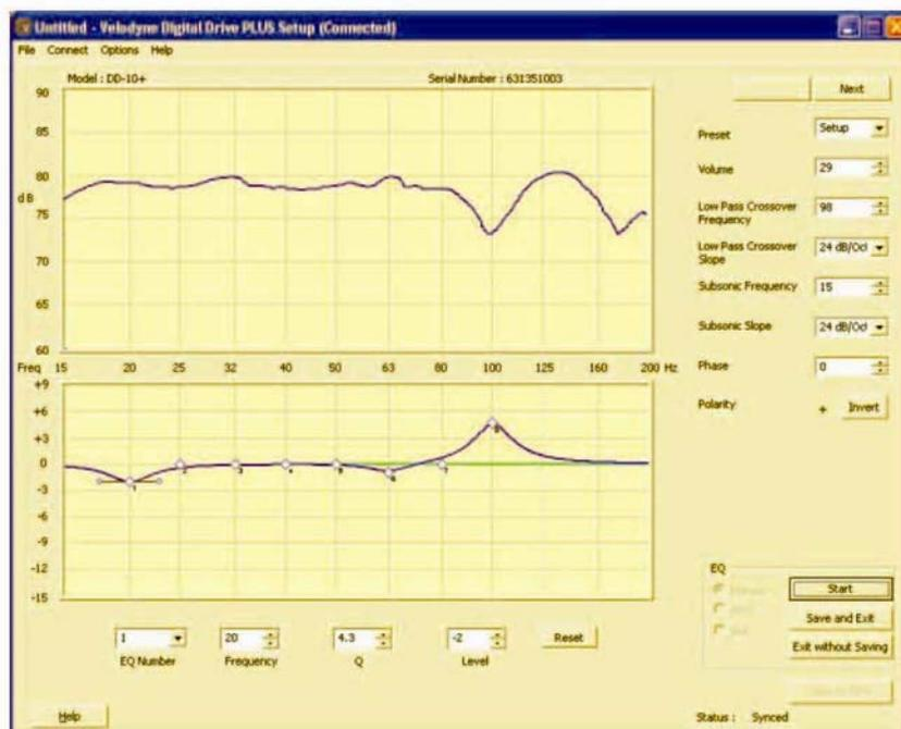
Bild 4: Auto-EQ<sup>PLUS</sup> Position 4, um 30 cm verschoben
